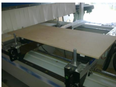
35. kép Alapanyag a CNC gépben
