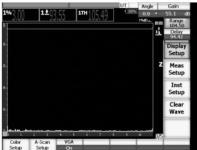
23. ábra: A kijelzőn felvett mérési tartomány képe (A-scan)
