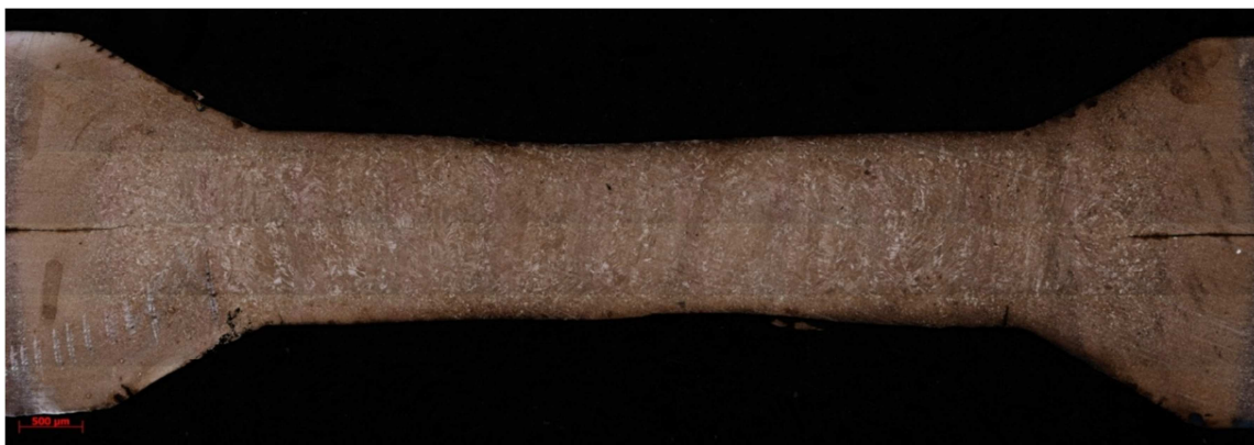
18. ábra. Pontheesztett kötés csiszolata 100x-os nagyítás alatt
