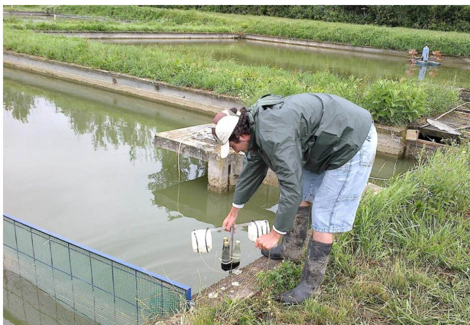
5. ábra: Mérés a sötét – világos palackokkal
