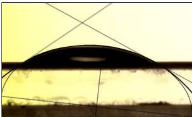
9. ábra: Peremszög meghatározása referencia Si felületen
