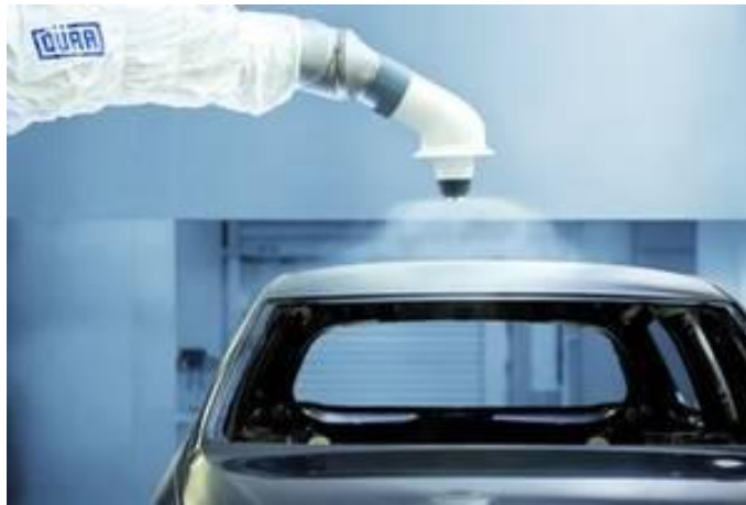
7. ábra Autók festésére használt elektrosztatikus forgó porlasztófej (forrás: http://www.globalspec.com/ )
