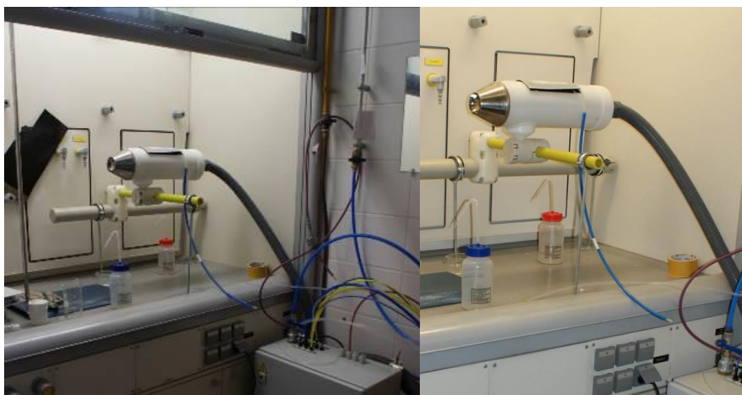
11. ábra Reiter HR Center Bell típusú nagysebességű porlasztó berendezés
