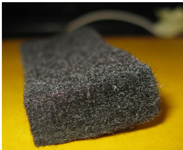
26. ábra: A kísérlet során alkalmazott elektródok: jobbra – grafitlap, balra – grafitszövet
