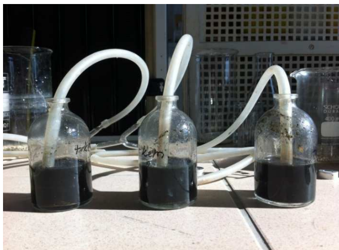
5. ábra A minták N 2 gázzal történő anaerobbá tétele
