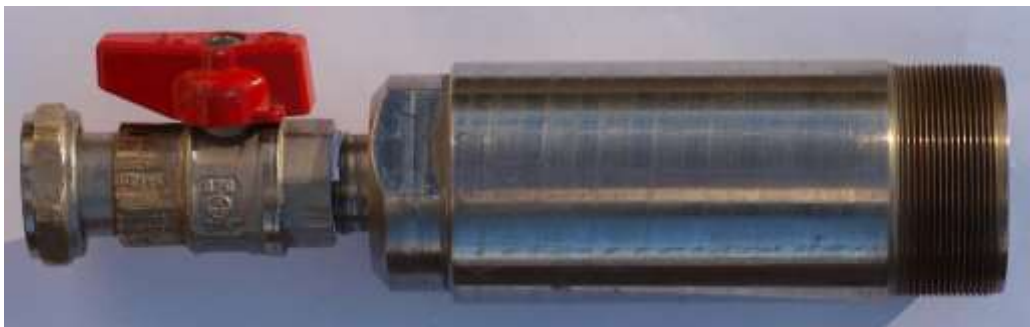
21. ábra: Gőzrobbantó tartály az expansziós szeleppel
