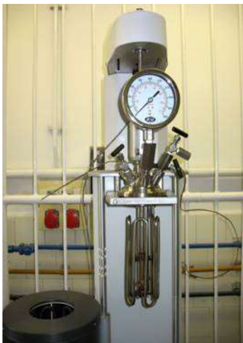
12. ábra: Parr reaktor fűtő és hűtő rendszere, mérőműszerei, keverőműve
