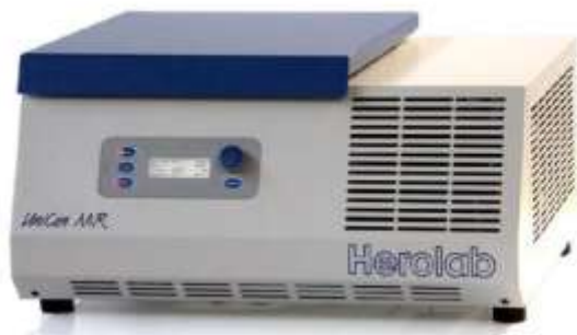
15. ábra: Herolab UniCen MR típusú fűthető-hűthető labor centrifuga készülékkel
