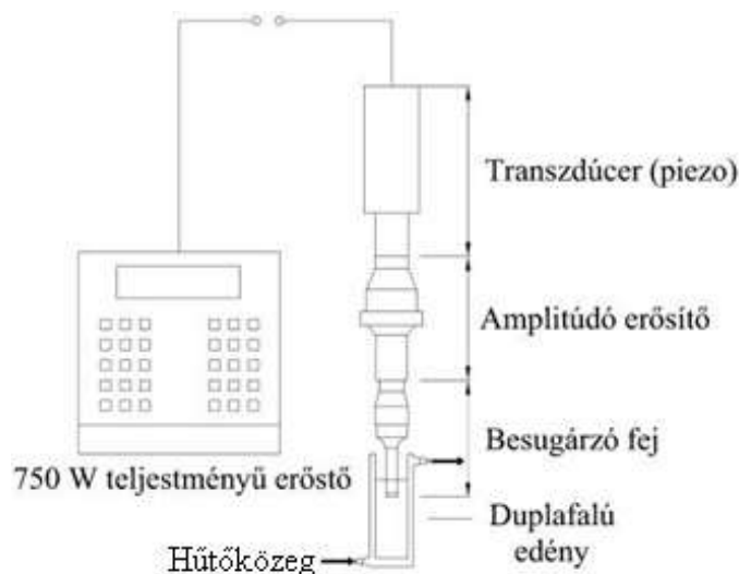
23. ábra: Az ultrahangos berendezés felépítése
