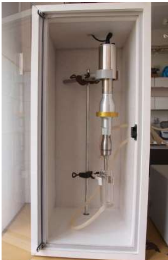
25. ábra: A hangszigetelő burkolattal ellátott ultrahangos berendezés
