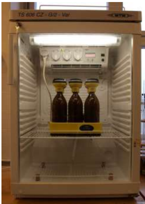
29. ábra: Összeállított BOI mérőrendszer a termosztáló egységgel
