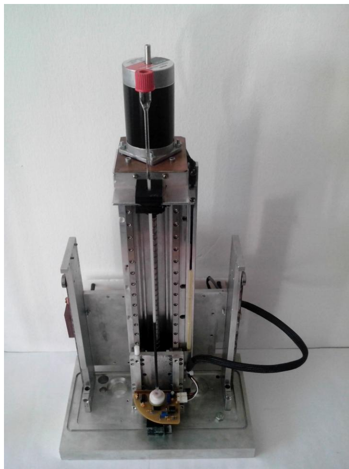
6.ábra: Magnetoreológiai folyadék ülepedését vizsgáló berendezés
