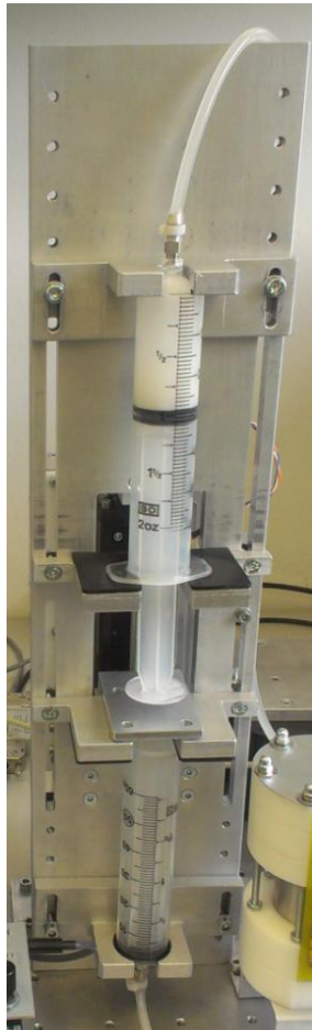
6. ábra Differenciális működtetésű mintaadagoló
