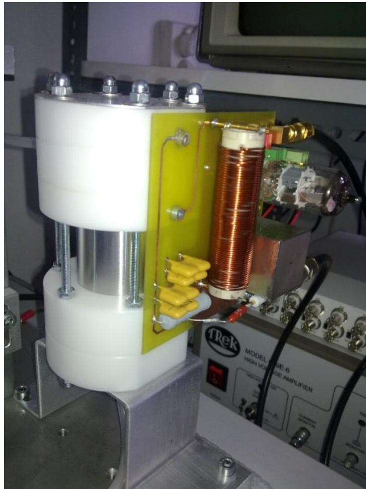
5. ábra A megvalósított áramlásos mérőcella és az LC oszcillátor
