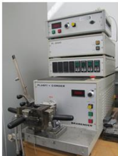
1. ábra: Brabender Plastograph gyúrókamra és Collin Teach-Line Platen Press 200E típusú labor prés
