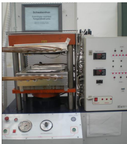
6. ábra: Schwabentan Polystat 300S présgép
