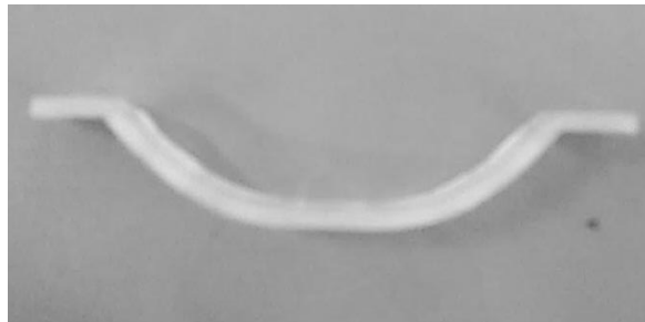
28. ábra: Erősítetlen referencia minta deformációja DMA vizsgálat közben
