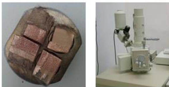
11. ábra: SEM vizsgálathoz előkészített minta és készülék
