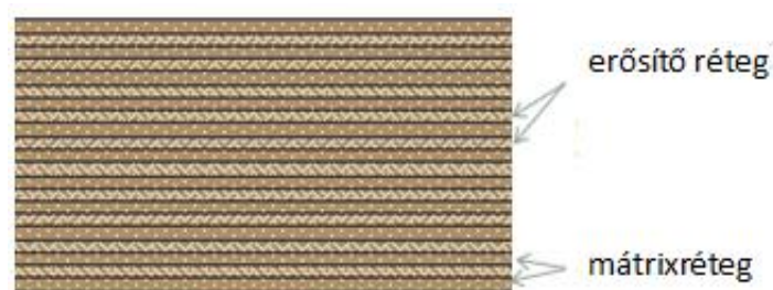
5. ábra: Kompozitgyártás sematikus rajza
