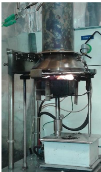
7. ábra: Cone kaloriméter
