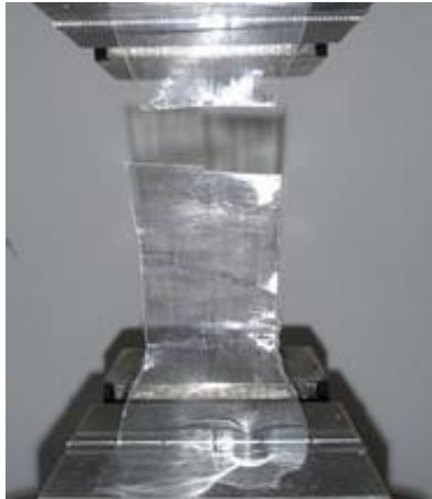
14. ábra: PLA fólia szakítása
