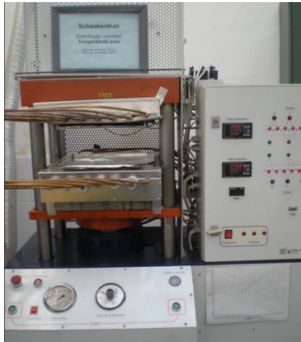
6. ábra: Schwabentan Polystat 300S présgép
