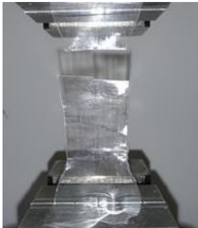
14. ábra: PLA fólia szakítása
