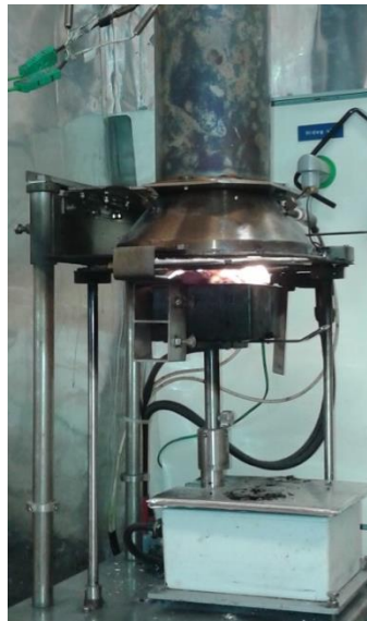
7. ábra: Cone kaloriméter
