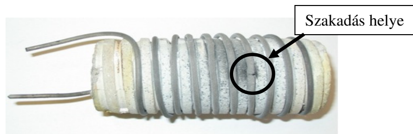
14. ábra: Szálszakadásos csőkemence
