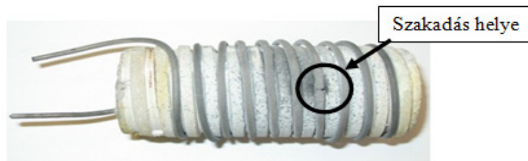
14. ábra: Szálszakadásos csőkemence
