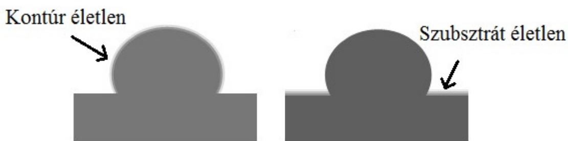
22. ábra: Élességi problémák a mérési képeken [24]
