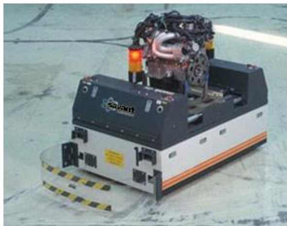
4. ábra Egy motorblokkot szállító AGV
