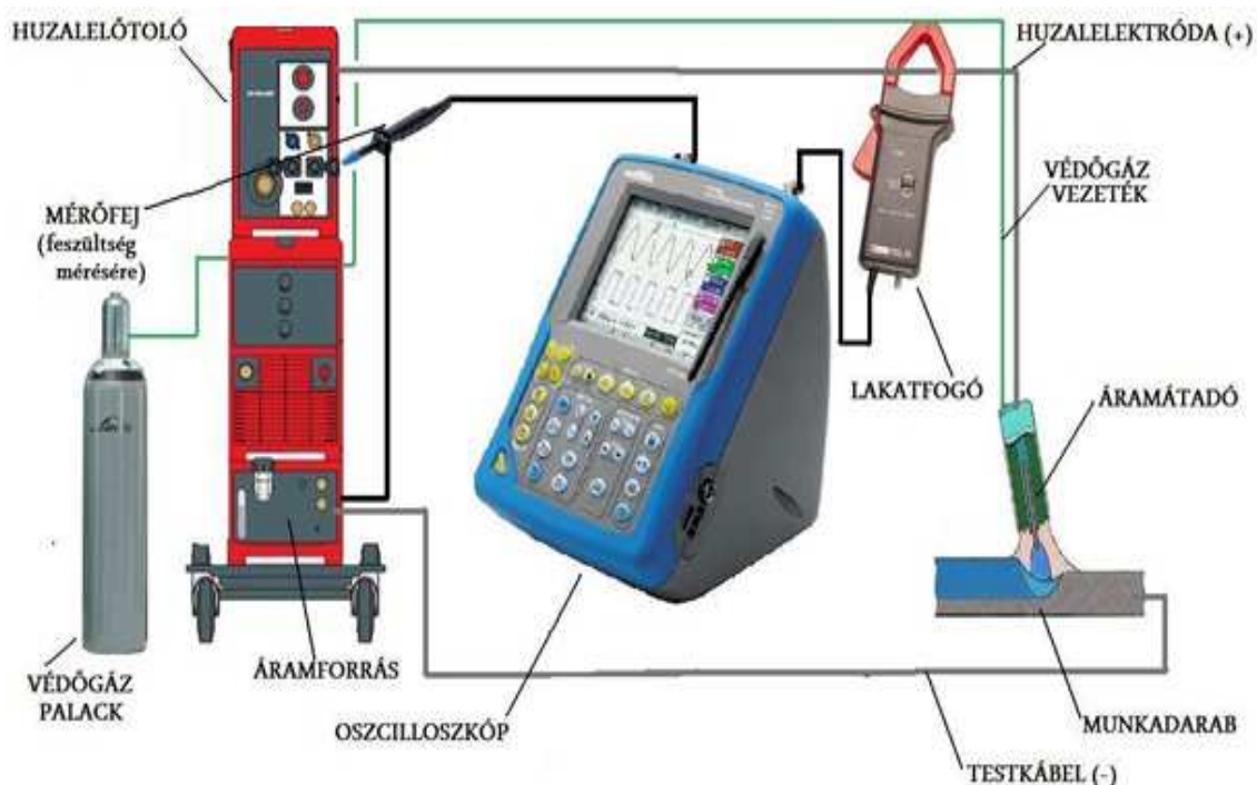
1. ábra: A mérés elrendezése [1]
