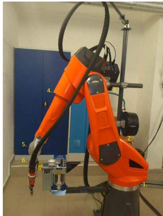
3. ábra - CLOOS QRC 320 típusú hegesztő robot tengelyei
