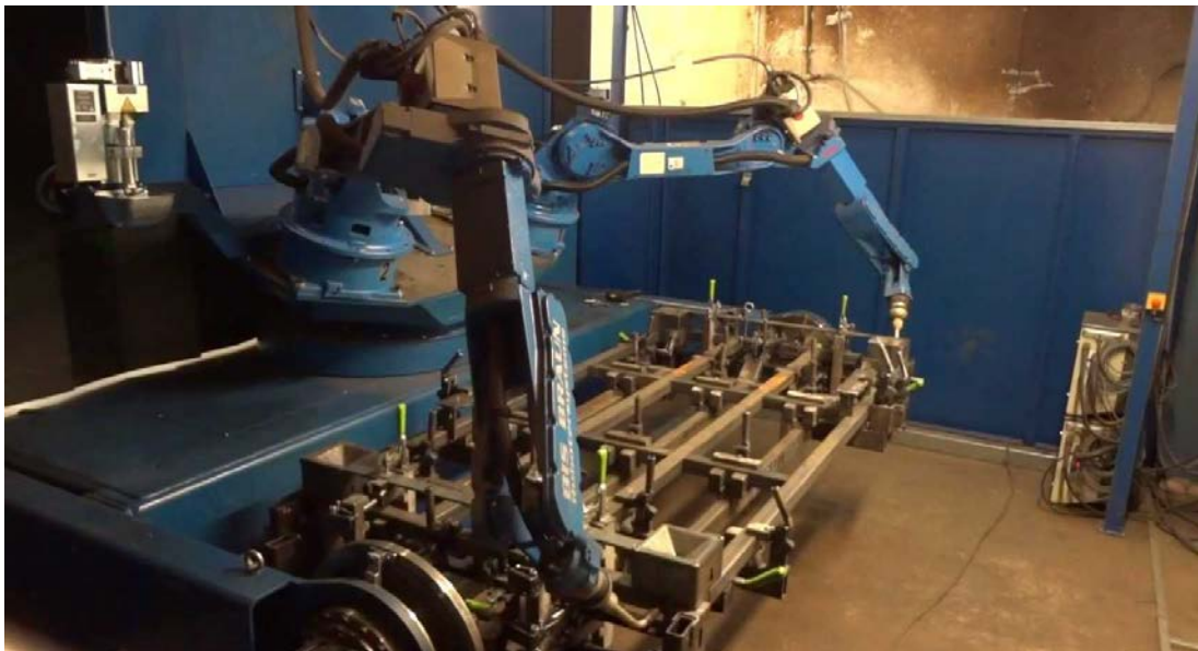
8. ábra – Két Motoman hegesztő robotból és egy forgóasztalból álló cella [6]
