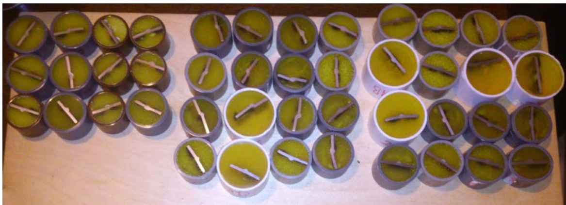
22. ábra – Varratok keresztmetszetinek mikro csiszolatai
