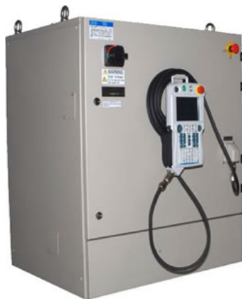
5. ábra - DX100-as vezérlő programozó egységgel, kapcsológommbal, vészleállító gommbal [5]
