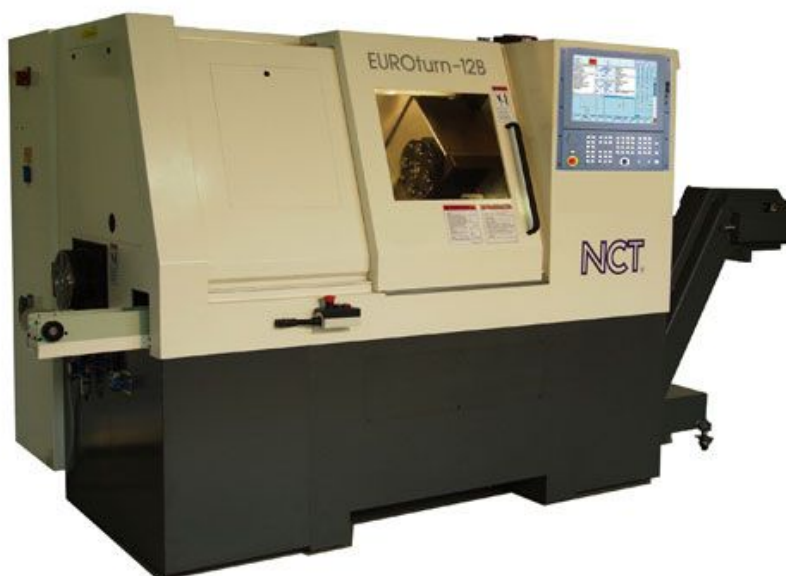
12. ábra EUROturn-12B ellenorsós CNC esztergagép [8]
