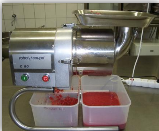
1. ábra Bogyópüré készítése Robot Coupe C80A passzírozó géppel
