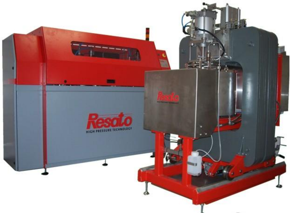
3. ábra RESATO FPU 100-2000 nagy hidrosztatikus nyomású berendezés
