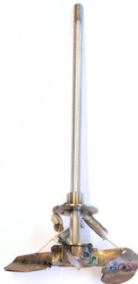
18. kép A rugós keverő végleges formája
