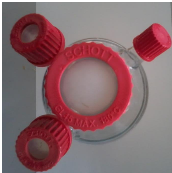
7. ábra A fermentor edény csatlakozási lehetőségei
