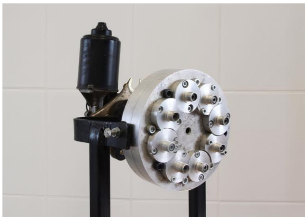
11. ábra A keverő motorja és a fogaskerék áttételek
