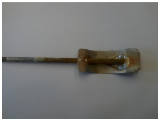
13. ábra A korrodálódott eredeti keverő
