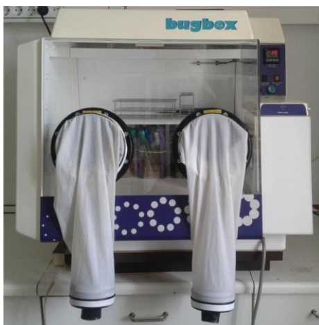
7. ábra: Az anaerob körülményeket biztosító Bug box
