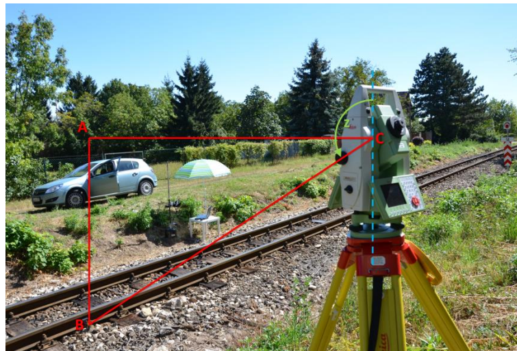
8. ábra: Trigonometriai magasságmérés szemléltetése
