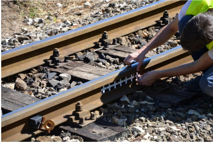
27. ábra: A matricák felhelyezése a mérési szelvényben
