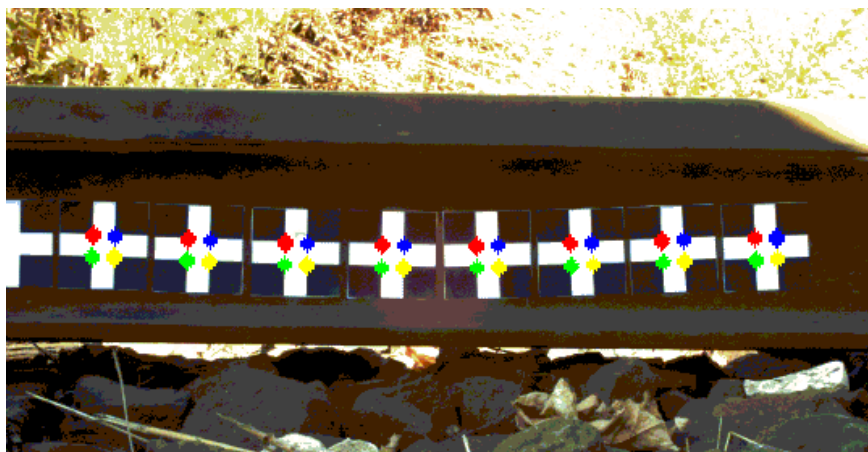
31. ábra: A vizsgált pontok elmozdulásai a 232-es vonat áthaladás során
