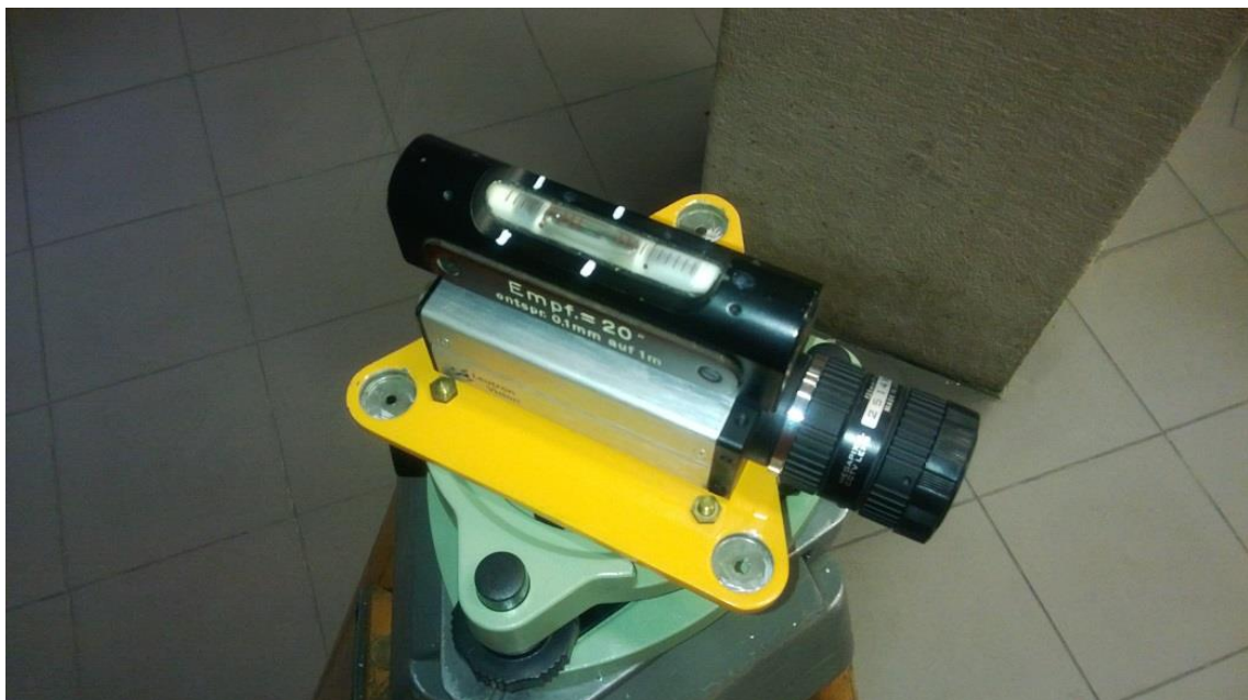
20. ábra: A kamera elhelyezése a vizsgálat alatt, vízszintesség beállítása közben
