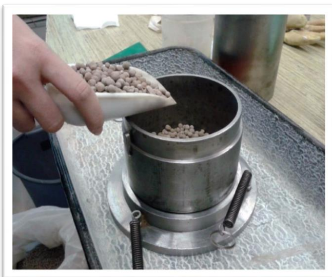
19. ábra Acélmozsár töltése adalékanyaggal
