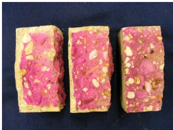
5.2 ábra. Három különböző karbonátosodási mélységű vizsgált próbatest
