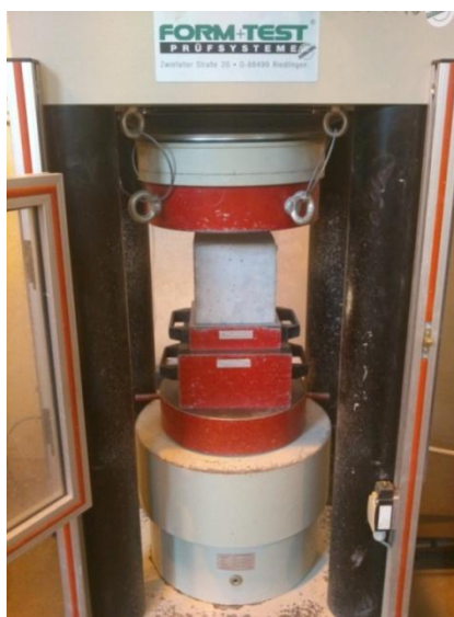
5.1 ábra. A beton nyomószilárdságának vizsgálata
