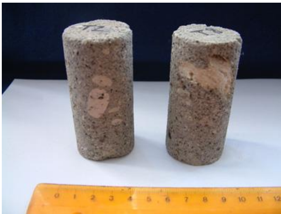
3.1. ábra. Riolittufából fűrt 2:1 arányú hengeres próbatestek.
