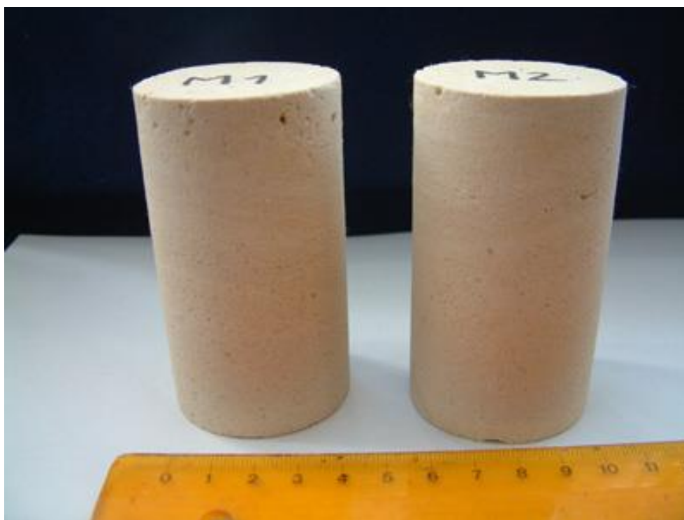
3.2. ábra. Durva mészkőből fűrt hengeres próbatestek
