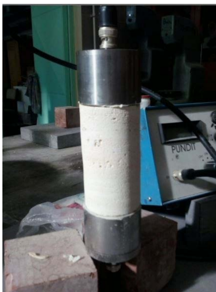
4.2. ábra. Próbatétel ultrahang terjedési sebesség mérése.
