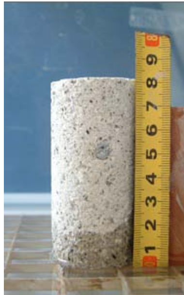
4.3. ábra. Próbatesszt kapilláris vízfelvételének vizsgálata.
