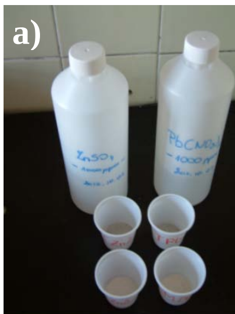
4.5. ábra. a) Porított kőzetminták nehézfém oldatba áztatva, b) Próbatetek nehézfém oldatok kapilláris felvétele.
