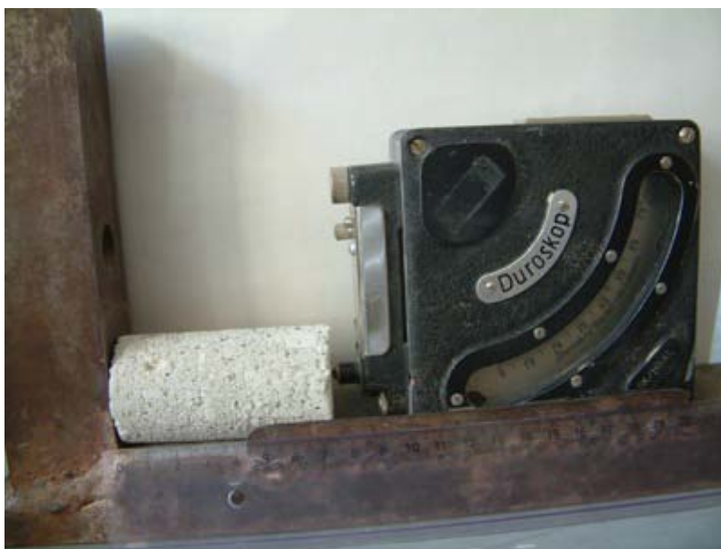
4.1. ábra. Próbatesszt felületi keménységének mérése Duroscoppal.
