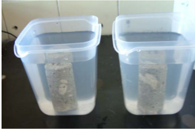
4.4. ábra. Nyílt porozitás vizsgálat.
