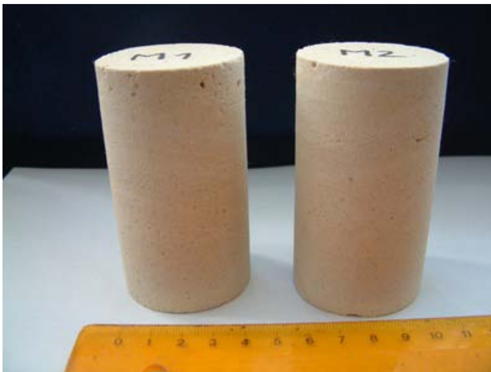
3.2. ábra. Durva mészkőből fűrt 2:1 arányú hengeres próbatestek
