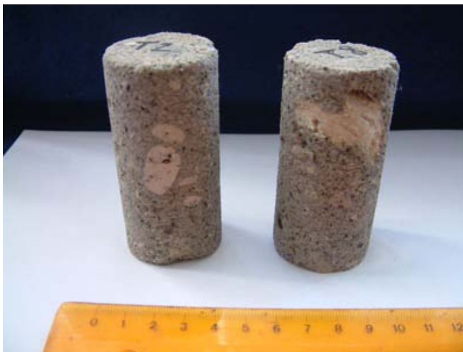
3.1. ábra. Riolittufából fűrt 2:1 arányú hengeres próbatestek.
