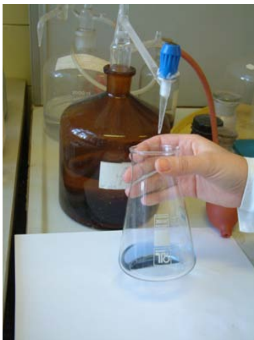
4.6.ábra. Visszamaradt oldatok titrimetriás meghatározása.
