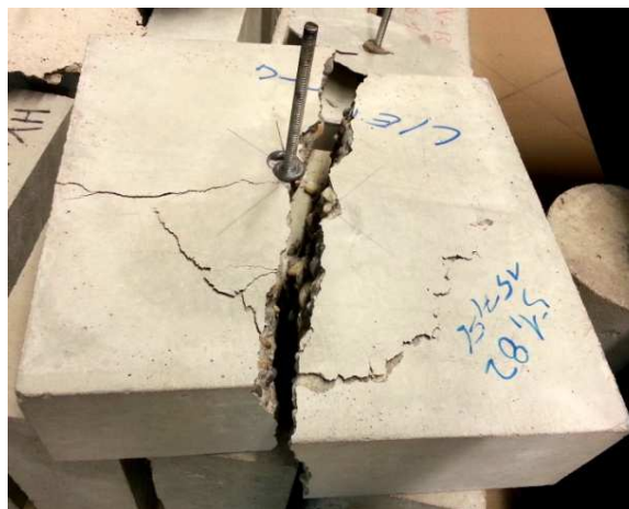
3.13 b. ábra – Póbatest felhasadása
