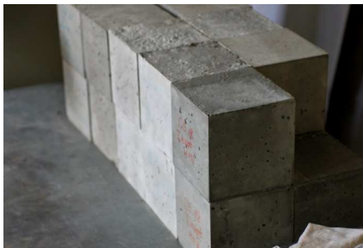
5.3. ábra – 150x150x150 mm-es próbakockák
