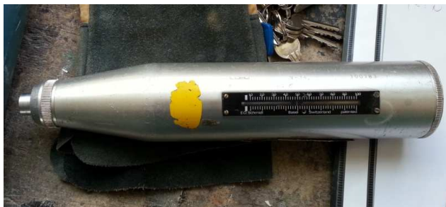
5.1 ábra – A vizsgálatához használt Schmidt-kalapács
