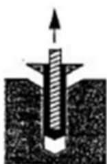
3.9 a. ábra – Kombinált tönkremenetel [4]
