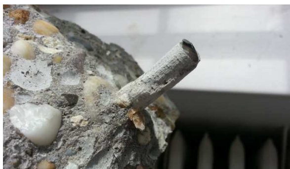
3.9 b. ábra – Kombinált tönkremenetel
