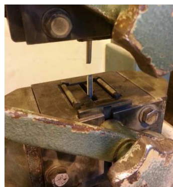
8.6. ábra – Mentes szár szakító vizsgálat
