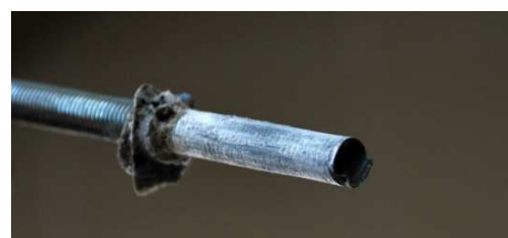
3.5. ábra – Ragasztó elnyíródás
