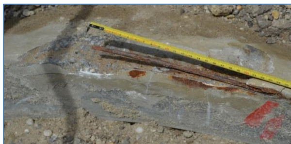
6.14. ábra: Tokvégnél kiálló feszítőhuzal (Kép készült: 2013. 05. 06.)
