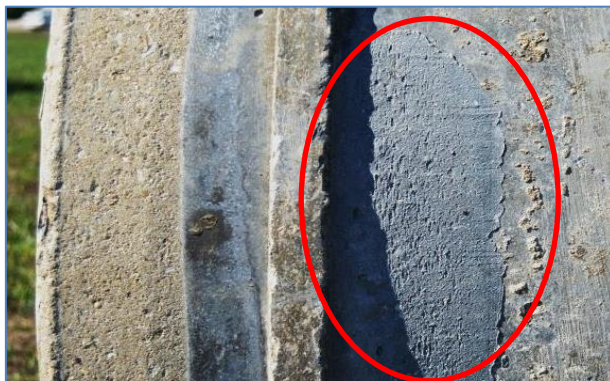
6.12. ábra: Cső felületén észlelt javítás (Kép készült: 2012. 08. 09.)
