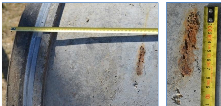
6.7. ábra: A csőszár végének közelében észlelt hosszanti rozsdafolt (Képek készültek: 2013. 07. 22.)
