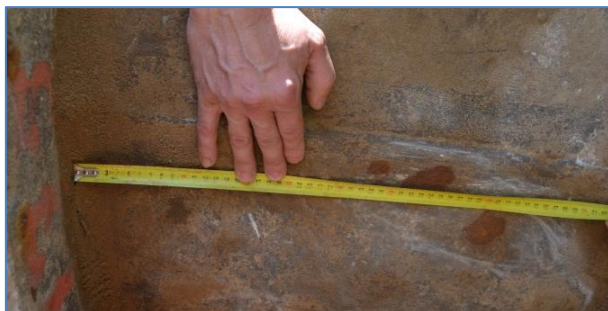
6.2. ábra: Zsaluillesztésnél észlelt rozsdafolt üzem alatti csövön (Kép készült: 2013. 04. 25.)
