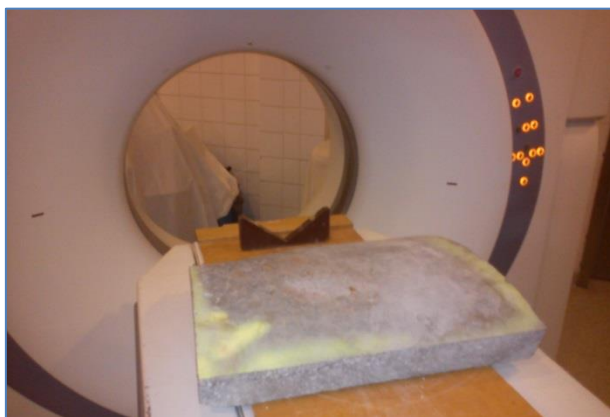
6.30. ábra: Kivágott csődarab CT vizsgálata (Képet készítette: Földes Tamás)
