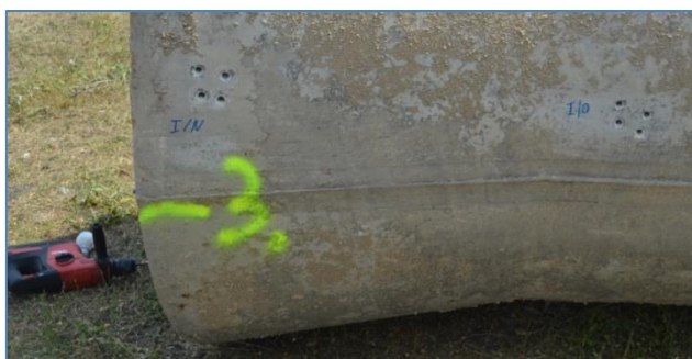
6.18. ábra: I. számú cső 3. oldalánál (beépítés szerinti alján) vett N és O jelű mintavételi helyek (Kép készült: 2013. 07. 18.)
