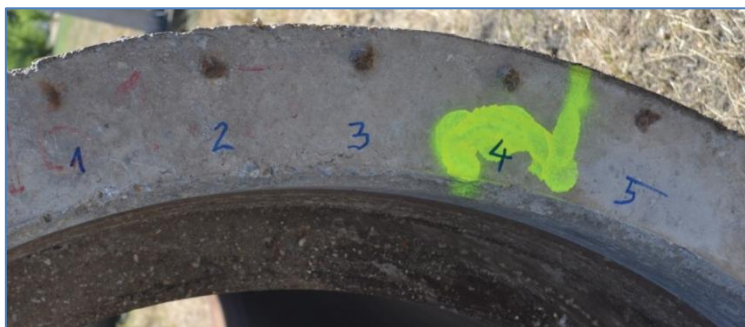
6.19. ábra: II. számú cső bütüs felületén tapasztalt rozsdafoltok (Kép készült: 2013. 07. 22.)
