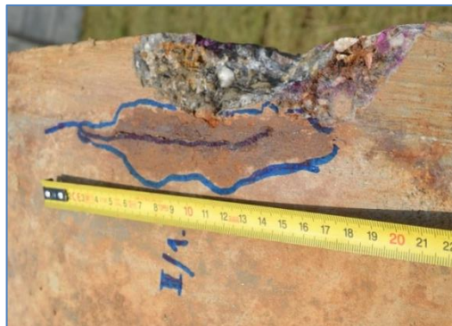
6.10. ábra: A tok végének közelében megfigyelt rozsdafolt a szemrevételezés elején és a rozsdatermék eltávolítását követően (Képek készültek: 2013. 07. 18.)
