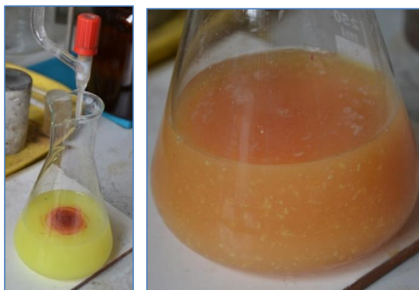
5.2. ábra: Kloridion tartalom meghatározása Mohr módszerrel (bal oldali ábra: vörös színű ezüstkromát képződése, jobb oldali ábra: nagy kloridion tartalom miatt fehér színű csapadék képződött, képek készültek: 2013. 07. 25.)
