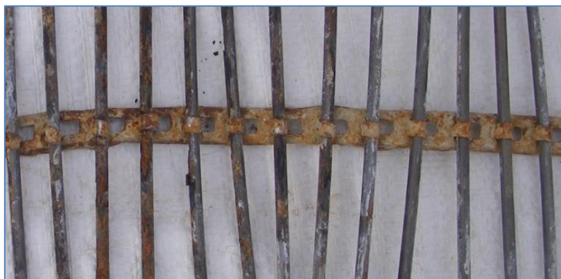
2.4. ábra: Az egyik helyszíni vizsgálatom során feltárt spirálhuzalrendező lécek (Kép készült: 2010. 11. 04.)
