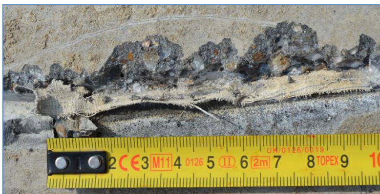
2.3. ábra: Fb-10-1200 típusú Sentab cső zsaluillesztésénél használt tömítő szalag (Kép készült: 2013. 07. 18.)
