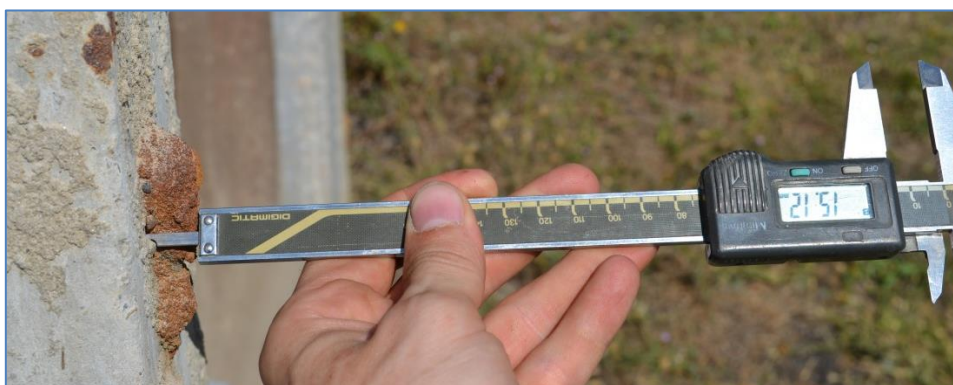
5.1. ábra: Cső бүтүс felületén észlelt rozsdafolt magassági méretének meghatározása tolómérő segítségével (Kép készült: 2013. 07. 17.)
