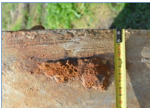
6.10. ábra: A tok végének közelében megfigyelt rozsdafolt a szemrevételezés elején és a rozsdatermék eltávolítását követően (Képek készültek: 2013. 07. 18.)
