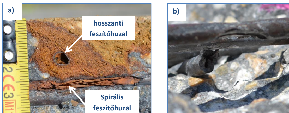
4.7. ábra: Feszítőhuzal lyukkorróziója az egyik vizsgált Sentab csövön, a) hosszanti betét teljesen kilyukadt, így a keresztmetszet jelentősen lecsökkent, míg a spirálisan futó betét belseje ugyancsak tönkrement, b) a hibahely feltárását követően a hosszanti feszítőhuzal megmaradt keresztmetszete, (Kép készült: 2013. 07. 17.)
