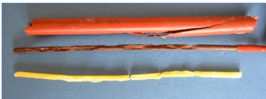
3.4. ábra: A feszítőbetét viasz másának készítése (legfölül látható a feszítőbetét körbeöntésekor keletkezett sablon, középen a mintavételhez használt feszítőbetét, míg legalul a feszítőhuzal viaszból készült mása, kép készült: 2012. 08. 08.)
