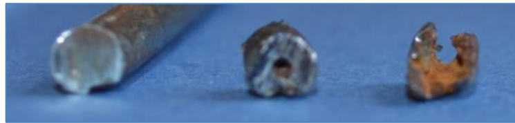
3.15. ábra: Feszítőhuzal 1cm-es darabjai (Kép készült: 2012. 07. 25.)
