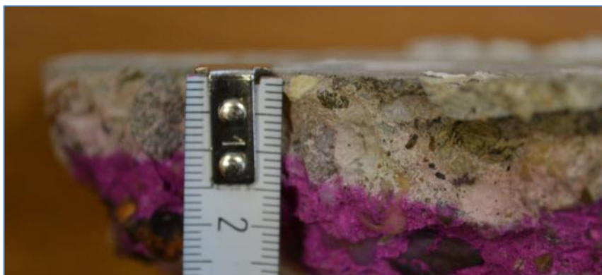
2.19. ábra: Hozzávetőlegesen 1cm karbonátosodási mélység kimutatása fenolftalein oldat segítségével (Képek készültek: 2013. 10. 16.)
