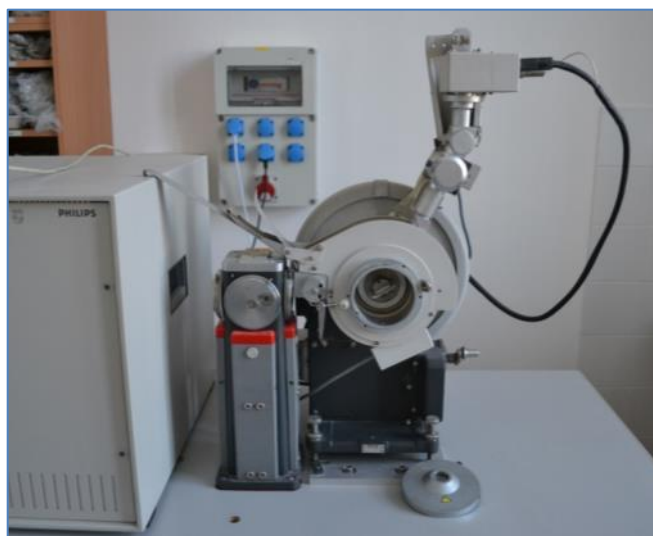
3.5. ábra: PHILIPS PW 3710 típusú diffraktométer (Kép készült: 2013. 10. 07.)
