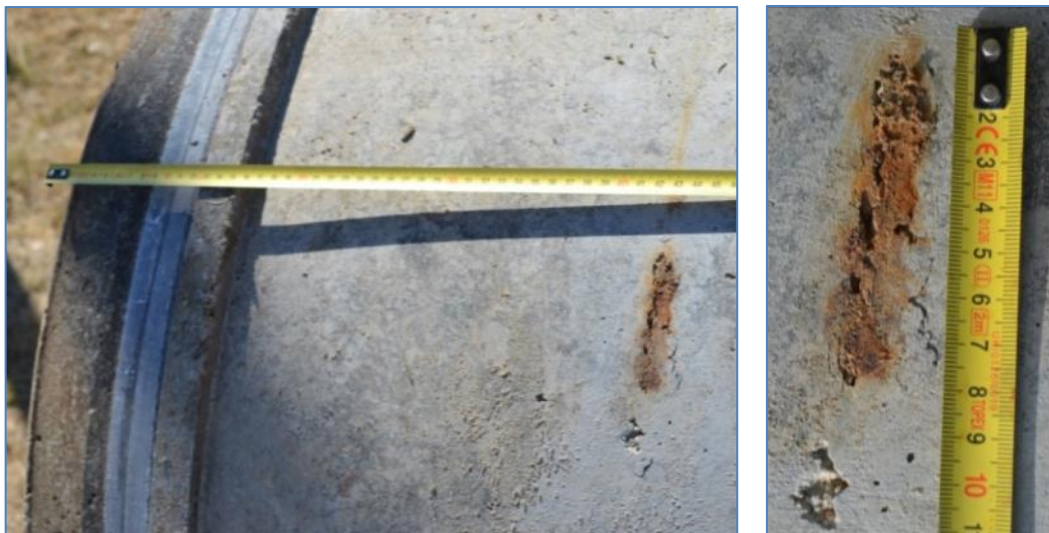
M.18. ábra: A csőszár végének közelében észlelt hosszanti rozsdafolt (Képek készültek: 2013. 07. 22.)
