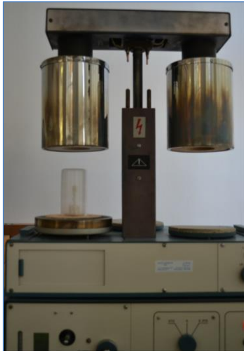
3.6. ábra: Derivatograph Q-1500 D készülék (Képek készültek: 2013. 10. 07.)
