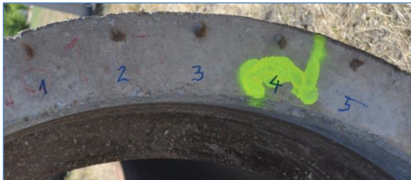
M.22. ábra: II. számú cső bütös felületén tapasztalt rozsdafoltok (Kép készült: 2013. 07. 22.)
