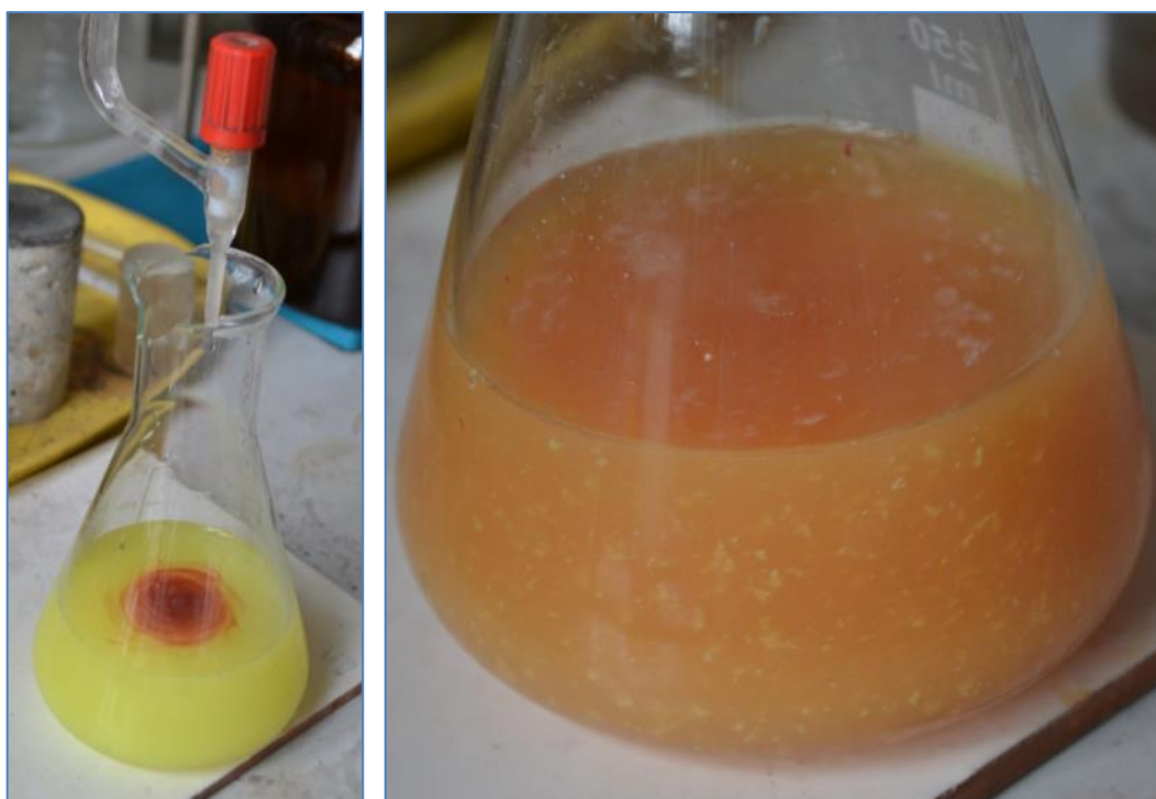
3.3. ábra: Kloridion-tartalom meghatározása Mohr módszerrel (bal oldali ábra: vöröses-barnáss színű ezüstkromát képződése, jobb oldali ábra: nagy kloridion-tartalom miatt fehér színű csapadék képződött, képek készültek: 2013. 07. 25.)
