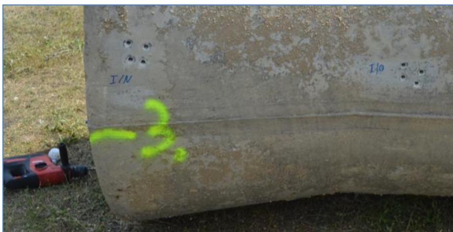
3.12. ábra: I. számú cső 3. oldalánál (beépítés szerinti alján) vett N és O jelű mintavételi helyek (Kép készült: 2013. 07. 18.)
