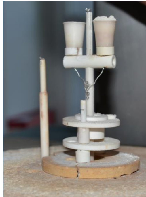
3.6. ábra: Derivatograph Q-1500 D készülék (Képek készültek: 2013. 10. 07.)
