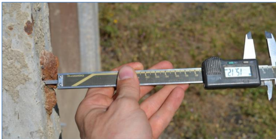
3.1. ábra: Cső bütös felületén észlelt rozsdafoltnál a rozsdatermék magassági méretének meghatározása tolómérő segítségével (Kép készült: 2013. 07. 17.)
