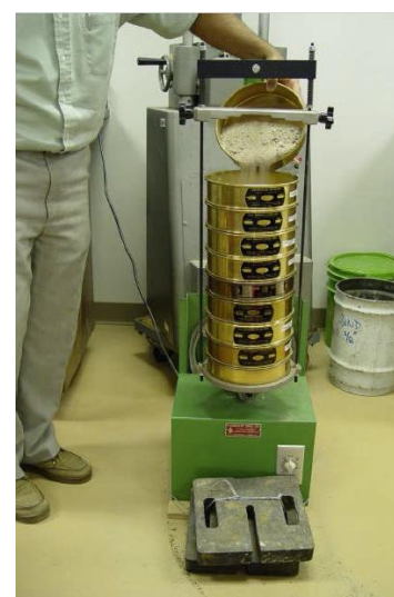
25. ábra: BÉTI 200 mm / 0,063-63 mm-es szitasor és PASCALL ENG. 12404 szitarázó [kép: Mahler András]
