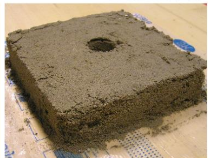
23. ábra: Talajminták származási helye és a segédfűtőlapos hővezetési tényező mérése utáni állapota
