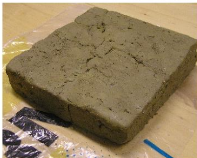
23. ábra: Talajminták származási helye és a segédfűtőlapos hővezetési tényező mérése utáni állapota
