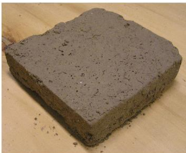
23. ábra: Talajminták származási helye és a segédfűtőlapos hővezetési tényező mérése utáni állapota
