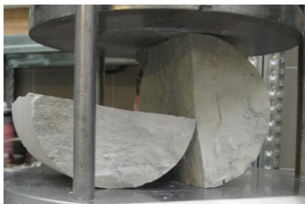
16. ábra: Jellegzetes töréskép (BSz-2/7 jelű próbatest)
