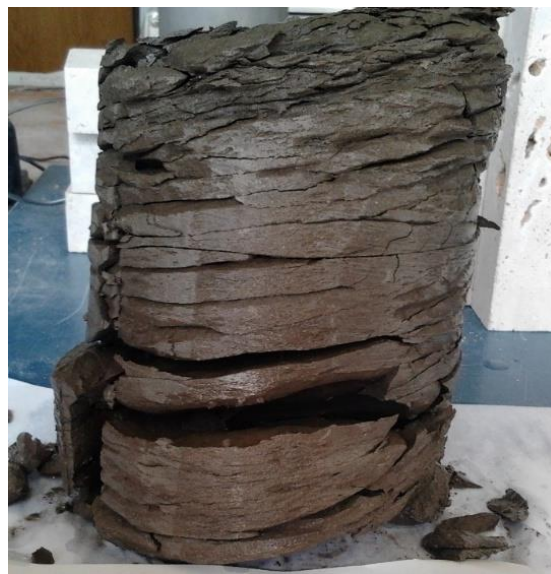
4. ábra: Telítés közben szétesett próbatest
