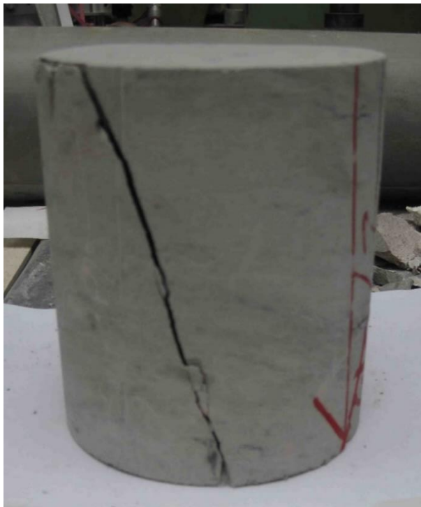
57. ábra: Tönkremenetel egy adott sík mentén
