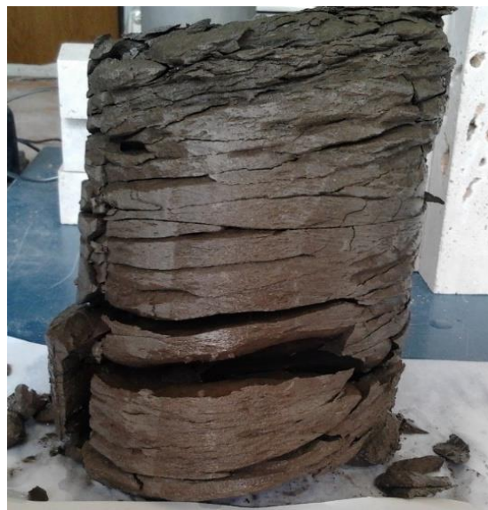
4. ábra: Telítés közben szétesett próbatest
