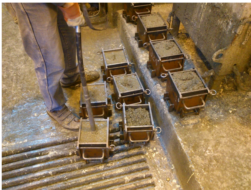
3-9. ábra: Beton tömörítése
