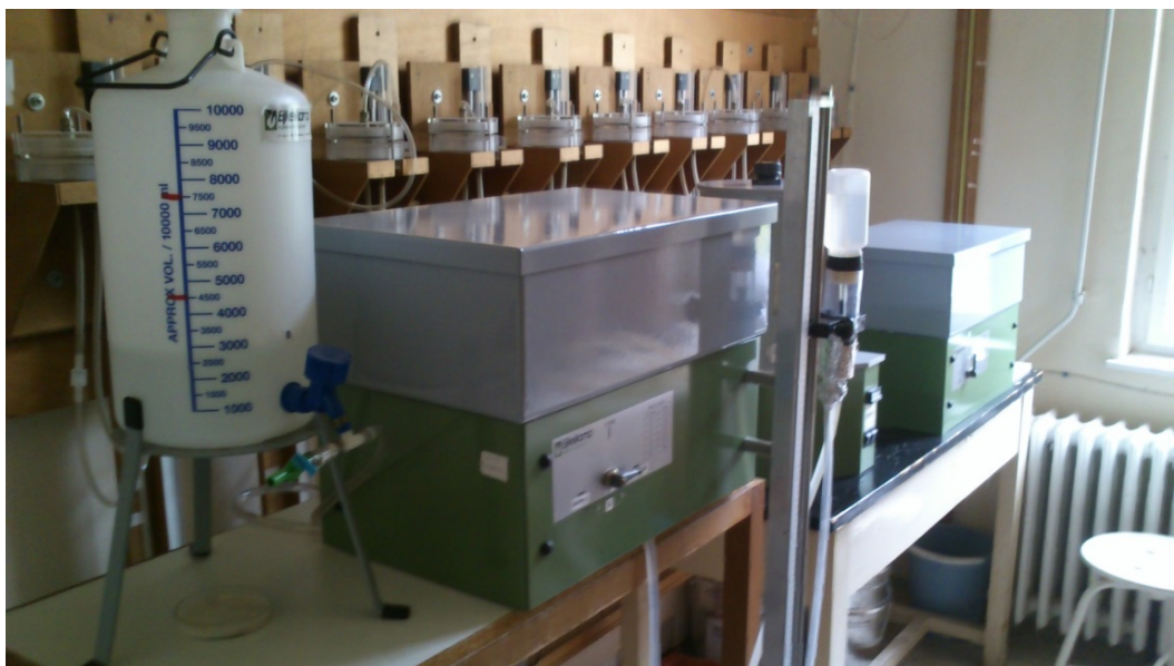
3-19. ábra: Víztartási görbe meghatározása gravitációs módszerrel
