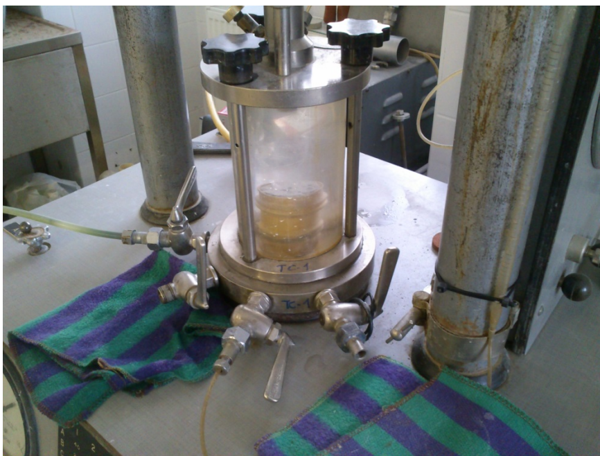
3-18. ábra: Vízáteresztő-képesség mérése triaxiális berendezéssel
