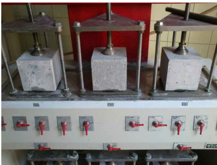
3-13. ábra: Vízjáróság vizsgálat az MSZ EN 12390-8:2009 szerint
