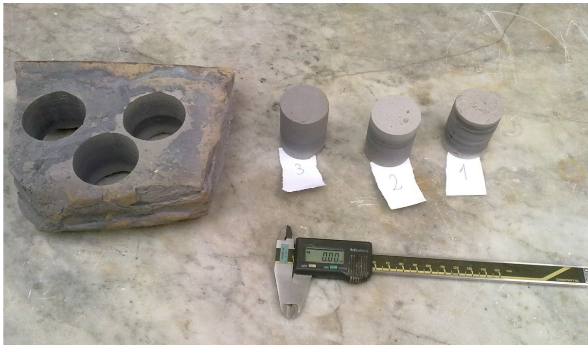
9. ÁBRA: MEGSZILÁRDULT PERNYEZAGY PRÓBATESTEK (FOTÓ: TURAI PÉTER)
