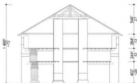
16. A lepencei burgus rekonstruált keresztmetszete (mérték méterben és orthodóron-ban)
