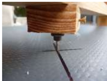
Szűrás próba a rétegrend középpontjában
