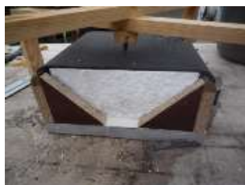
Kétoldali megfogás négy helyett
