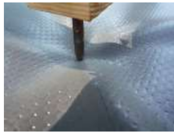
Az átszűrődést csak hallás alapján lehet megállapítani
