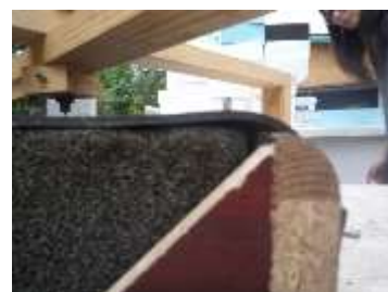
A vízszigetelés nem törik a doboz szélén
