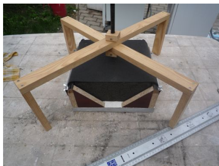
A végleges mérőeszköz jellemzői: henger alakú szűrőfej, a szigeteléseket rögzítő doboz és a szakaszos, vízzel történő terhelés.
