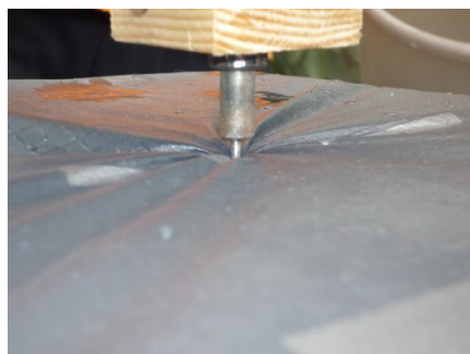
A végleges mérőeszköz jellemzői: henger alakú szűrőfej, a szigeteléseket rögzítő doboz és a szakaszos, vízzel történő terhelés.
