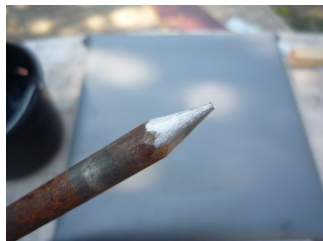
Az első tompított végű kúp fejforma és a végleges 2 mm átmérőjű, viszonylag éles peremű, henger alakú szűrőfej.
