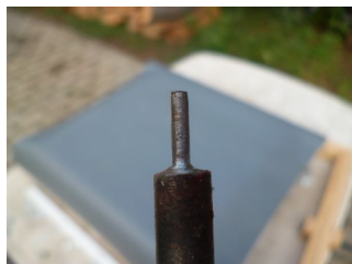
Az első tompított végű kúp fejforma és a végleges 2 mm átmérőjű, viszonylag éles peremű, henger alakú szűrőfej.
