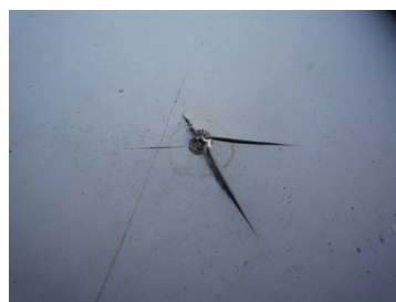
A pontszerű kvázi statikus teher hatására keletkező tönkremenetel példái: bevonatszigetelés repedése, látszólagos átszakadt lemez deformációja az alsó felületen, a valószínűleg szálon eltalált vízszigetelést felvágva vizsgáltuk meg
