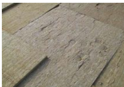
A képek a dinamikus pontszerű teher által a kőzetgyapot táblákon okozott deformációit mutatja meg és a kísérleti eszközt.
