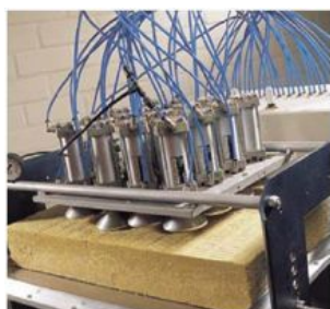
A képek a dinamikus pontszerű teher által a kőzetgyapot táblákon okozott deformációit mutatja meg és a kísérleti eszközt.
