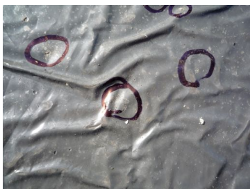
A pontszerű kvázi statikus teher hatására keletkező tönkremenetel példái: bevonatszigetelés repedése, látszólagos átszakadt lemez deformációja az alsó felületen, a valószínűleg szálon eltalált vízszigetelést felvágva vizsgáltuk meg
