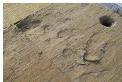
A képek a dinamikus pontszerű teher által a kőzetgyapot táblákon okozott deformációit mutatja meg és a kísérleti eszközt.
