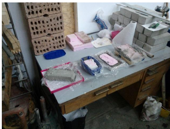
8. kép: Próbaöntések a zsaluzattól való elválaszthatóság tesztelésére
