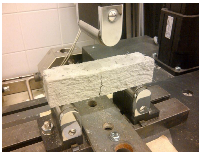
6. kép: Mikroszál adalékanyagú próbatest hajlítása a beton berepedése után
