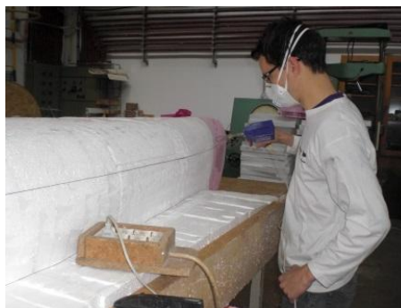
12. kép: Hosszboarda kialakítása forrasztópákával
