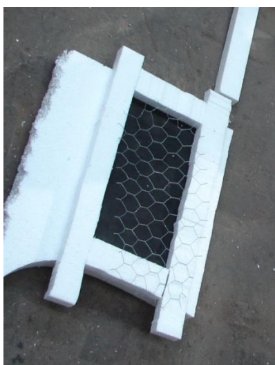
9. kép: A próbatest EPS zsaluzata a geotextília és a csirkeháló réteggel
