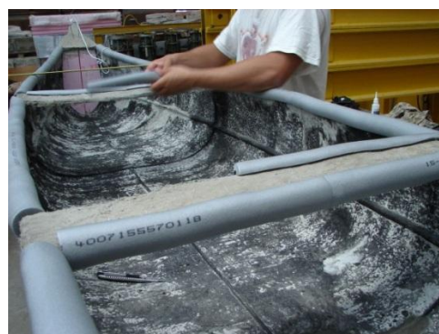
5. kép: Peremerősítés (polifoam csővel védve) és keresztborda
