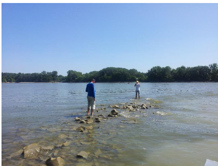
10. ábra – Sarkantyú koronaszint mérése RTK GPS-szel /Készítette: Baranya Sándor/
