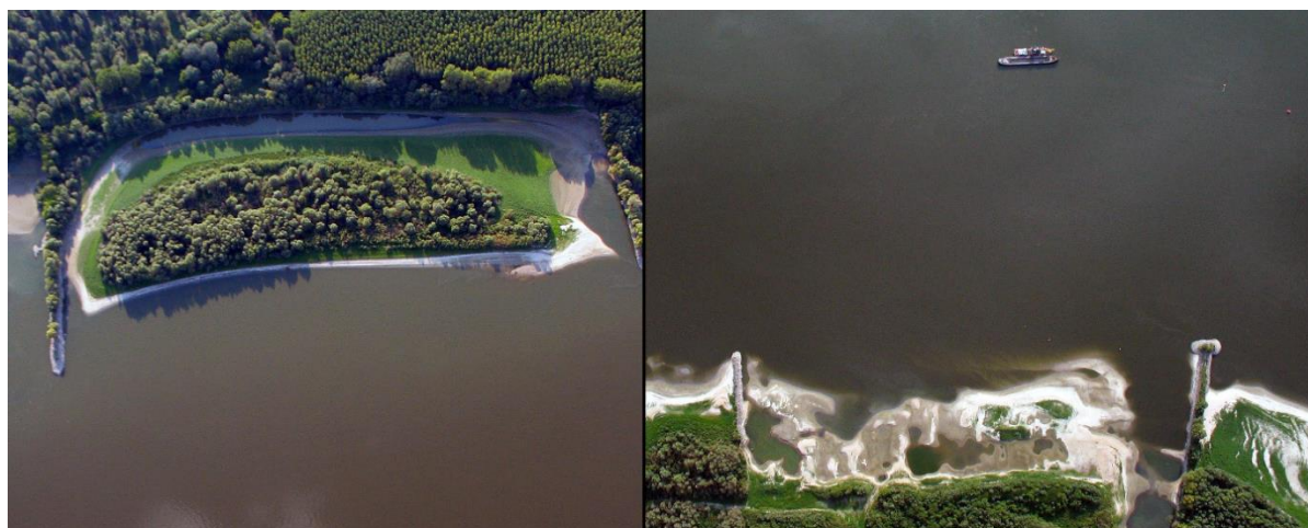
27. ábra – Sarkantyúk közötti feltöltődések a Solt és Kalocsa közötti Duna-szakaszon /Készítette: Keve Gábor/
