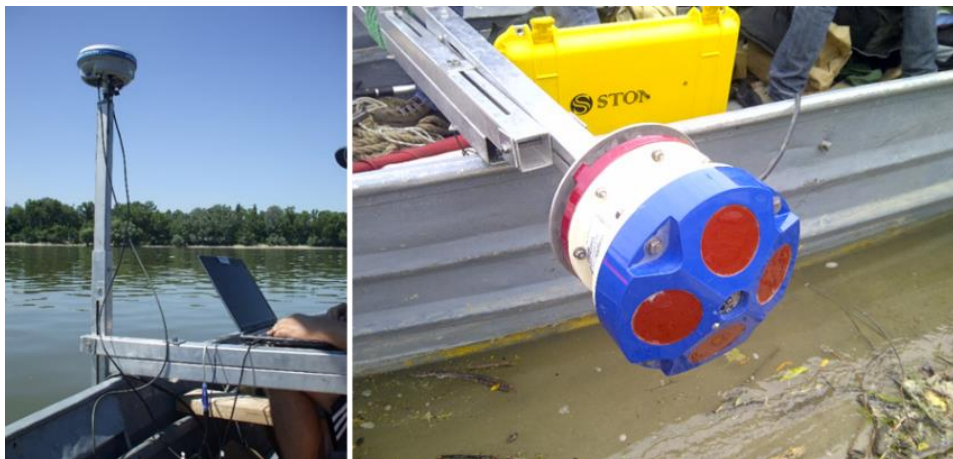
8. és 9. ábra – ADCP-hez kapcsolt GPS jelnevő és az adatfeldolgozó számítógép /Saját fénykép/; Négy fejes ADCP műszer /Saját fénykép/
