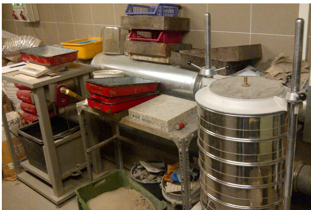
14. ábra – Mederanyag minta laboratóriumi vizsgálata szitasorral /Saját fénykép/
