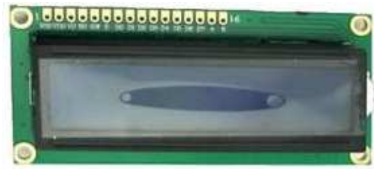
33. ábra A QC1602A LCD-kijelző
