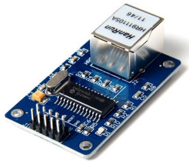
17. ábra: Az alkalmazott Ethernet SPIátjáró modul
