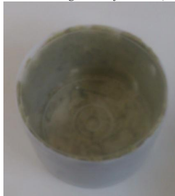
16. ábra: Kaloriméter belső hengerei közetgyapotot szigeteléssel ellátva (Forrás: saját készítés)
