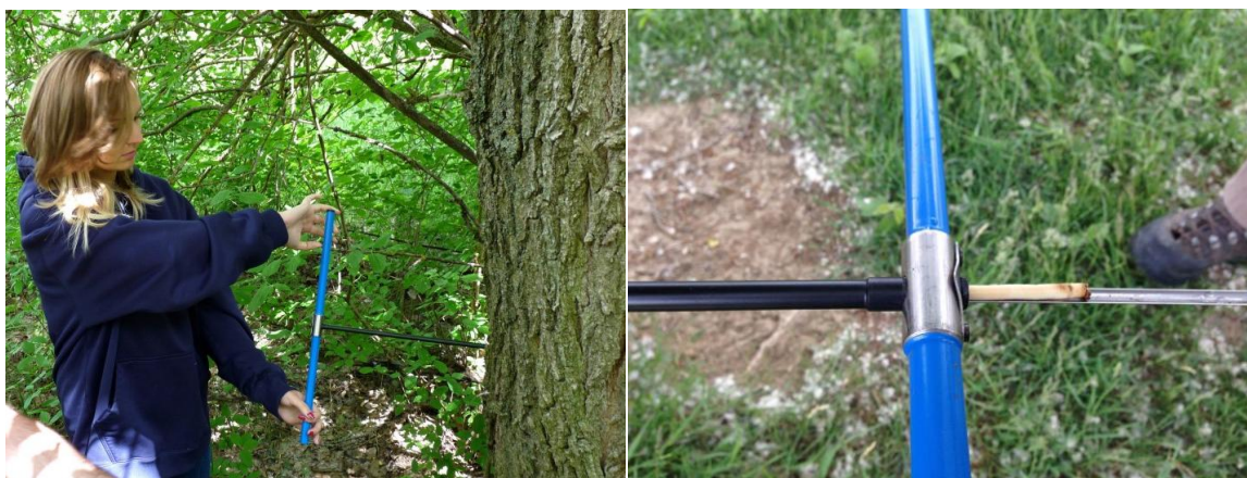
10.ábra Faévgűrű mintavétel fúrós technikával, a háttér fából
