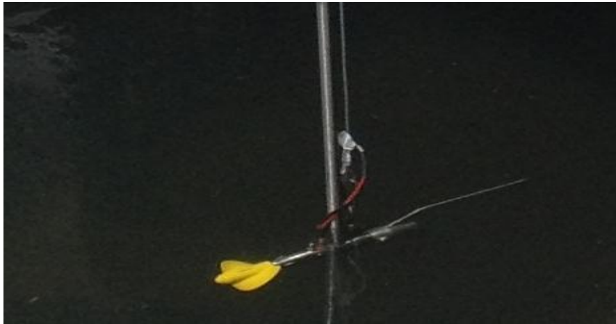
19. ábra Forgószárnyas mérőberendezés mérés közben a Körös-éren 2013.05.02.én
