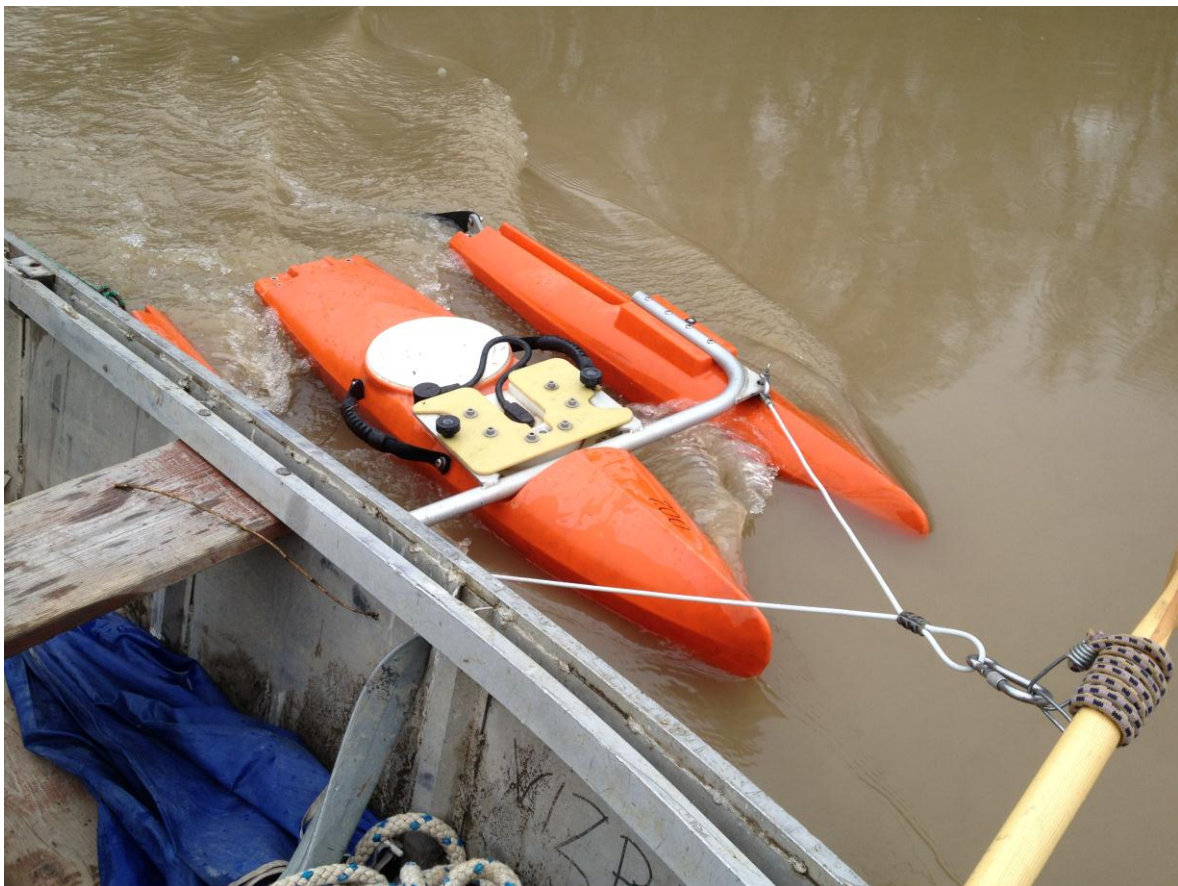
20. ábra ADCP berendezés Tiszai árvizes mérés közben
