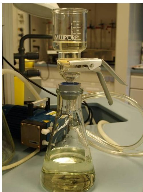
11. kép Minta szűrése (forrás: Molnár Anita)
