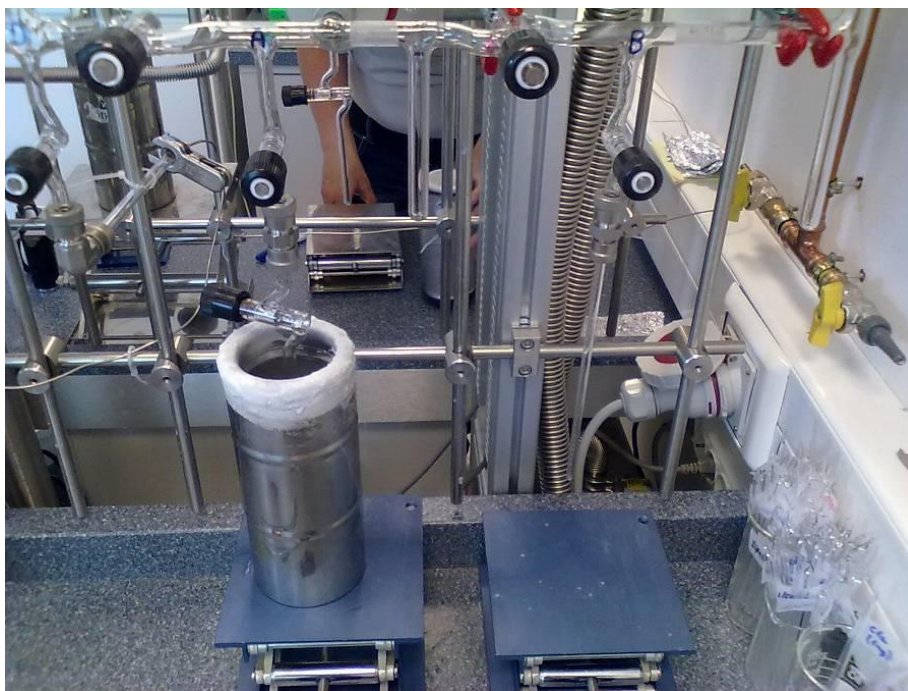
6. kép Ismert térfogatú rész a feltárási rendszeren (forrás: Molnár Anita)
