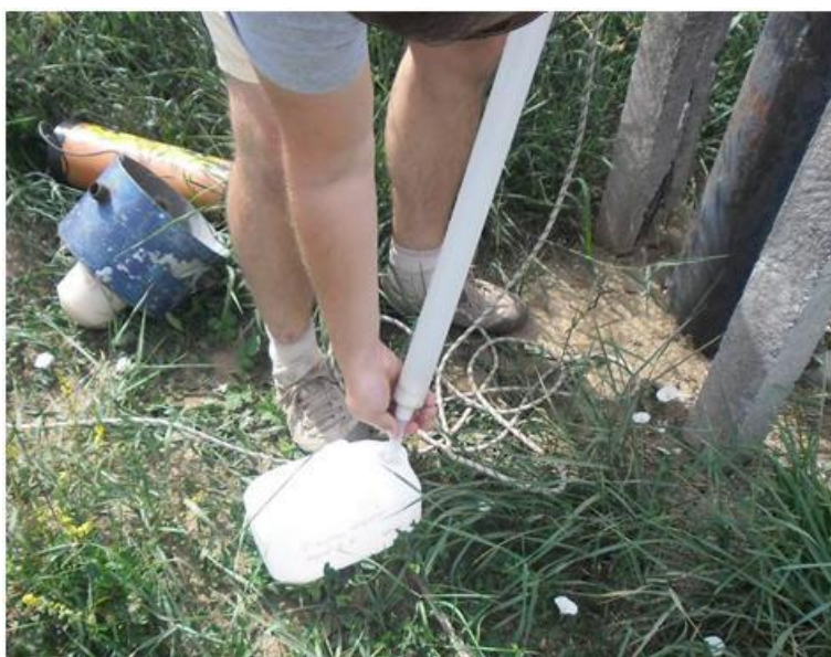
4. kép Mintavétel a Püspökszilágyi RHFT egyik talajvízfigyelő kútjából (forrás: Molnár Anita)
