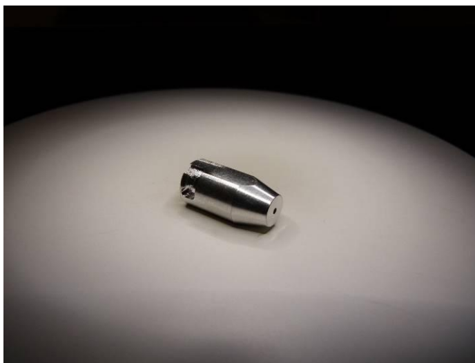
21. kép A mintát tartalmazó target (forrás: ATOMKI)
