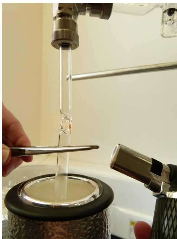
18. kép CO 2 -Minta leszúrása zártcsöves grafitizáló rendszeren (forrás: Molnár Anita)
