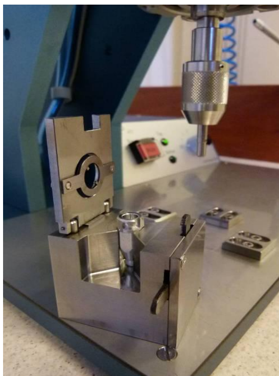
20. kép A grafit targetbe való helyezése préssel történik (forrás: ATOMKI)
