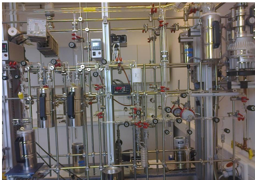
15.kép AMS feltárási rendszer (forrás: Molnár Anita)
