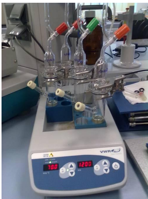
7. kép Vízminta melegítése savadagolást követően (forrás: Molnár Anita)
