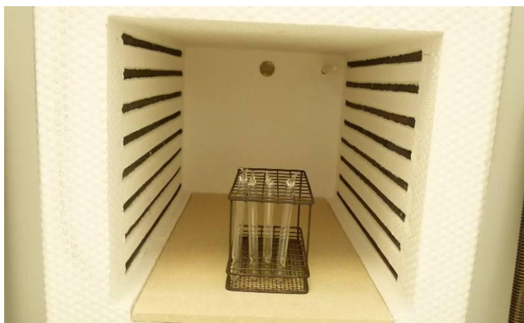
19.kép Minták grafitizálása kemencében (forrás: ATOMKI)
