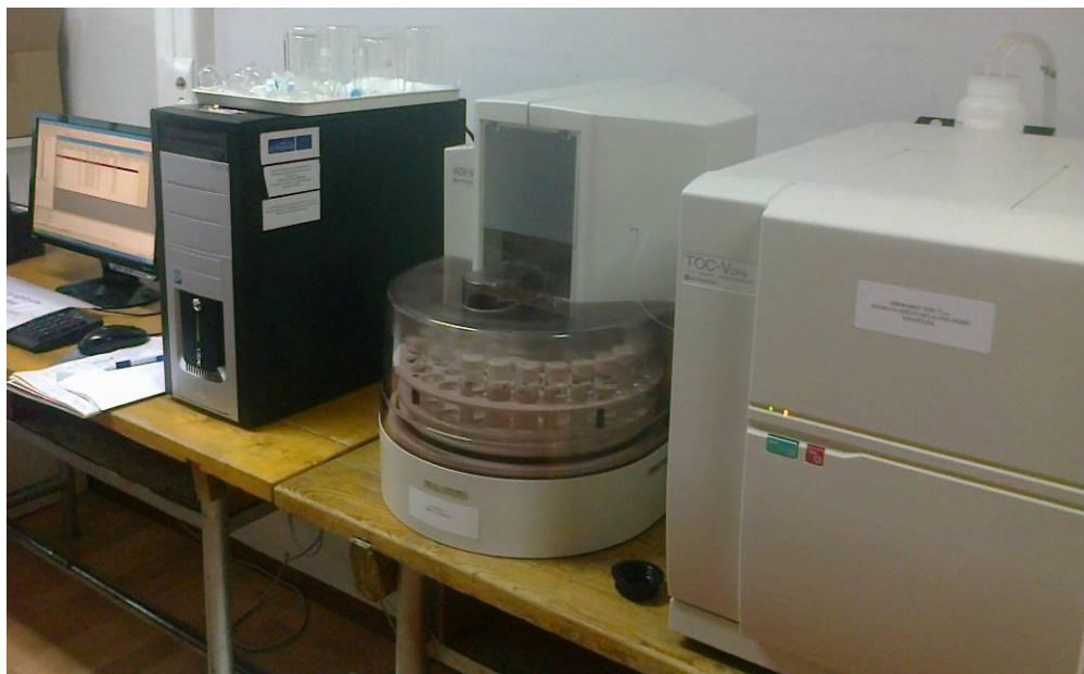
5. kép Shimadzu TOC-V CPN készülék (forrás: Molnár Anita)
