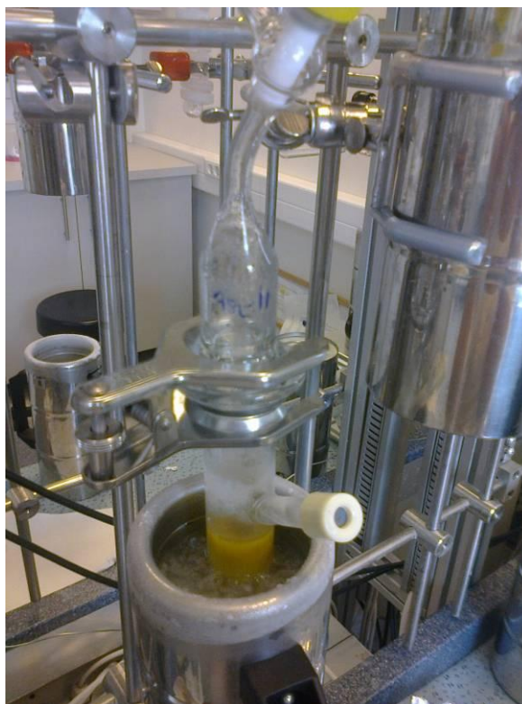
16.kép Minta befagyasztása a feltáró rendszeren (forrás:
