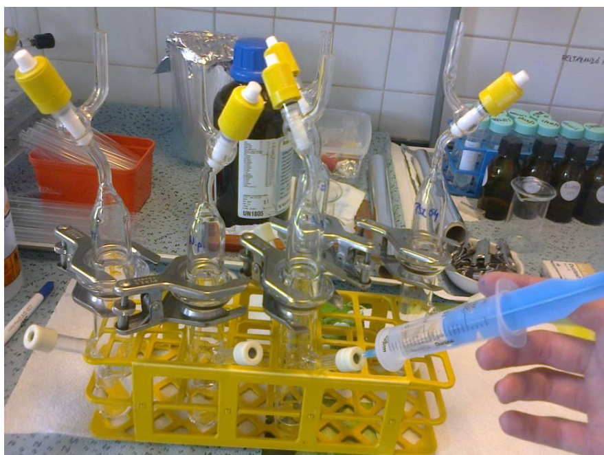
13. kép Mintaadagolás és szűrés szeptumos ampullába (forrás: Molnár Anita)
