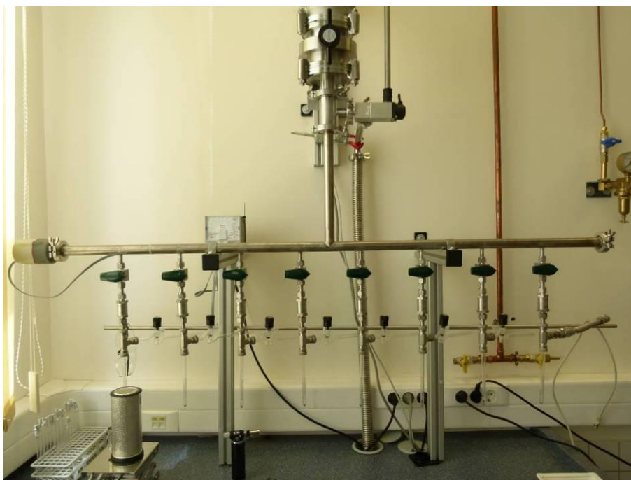
17. kép Zártcsöves grafitizáló rendszer (forrás: Molnár Anita)
