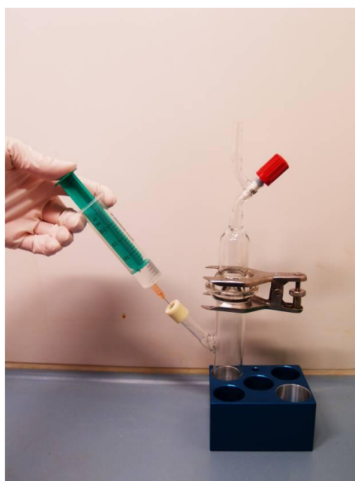
12. kép Foszforsav adagolás a szeptumon keresztül (forrás: ATOMKI-HEKAL)
