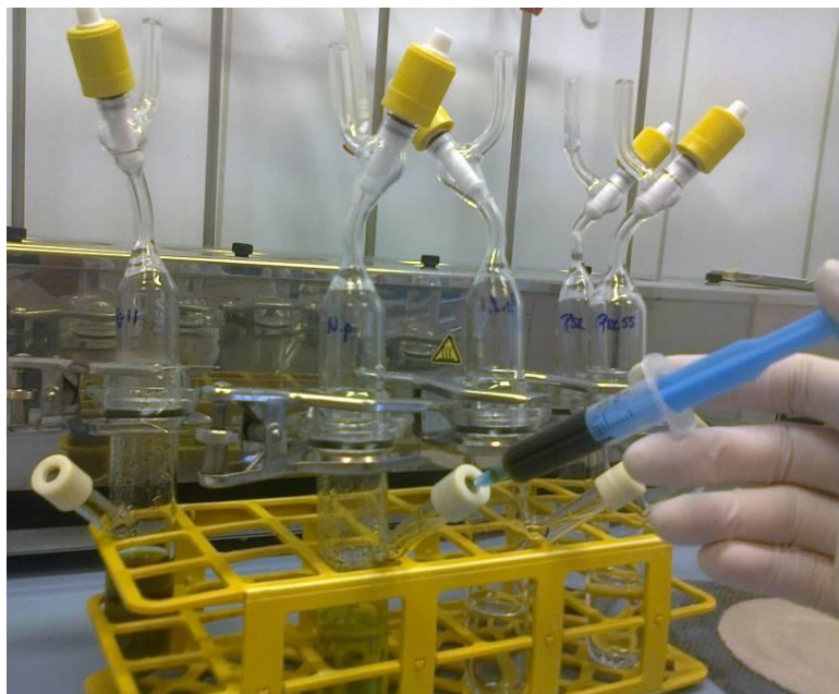
14.kép Krómkénsav adagolása a mintához TC kiűzése céljából (forrás: Molnár Anita)
