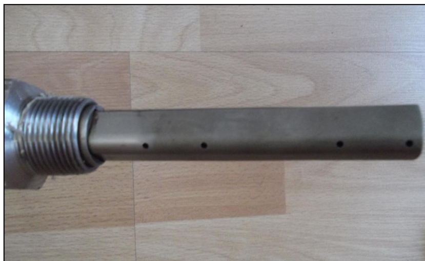
4-1. ábra: Annubar szondafej menetes csatlakozóval (Forrás: Saját készítésű kép)
