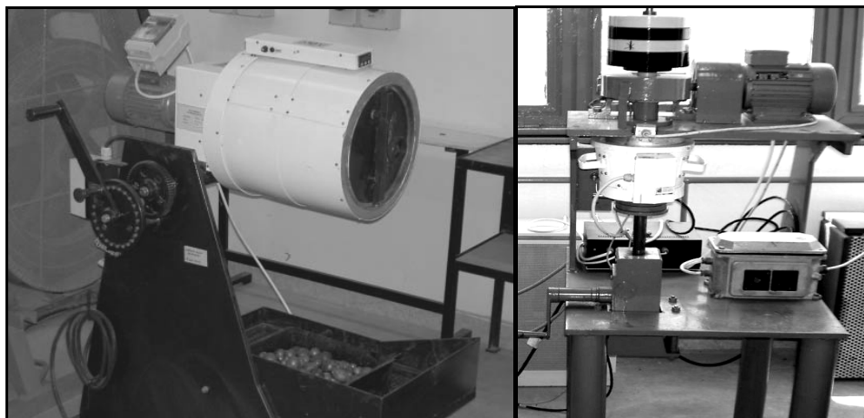
4. ábra: Miskolci Egyetem, Nyersanyagelőkészítési és Környezeti Eljárástechnikai Intézet Bond- és Hardgrove-malma
