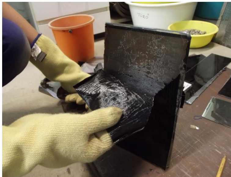
31. ábra: Polarizáló fólia leválasztása hőkezelés után
