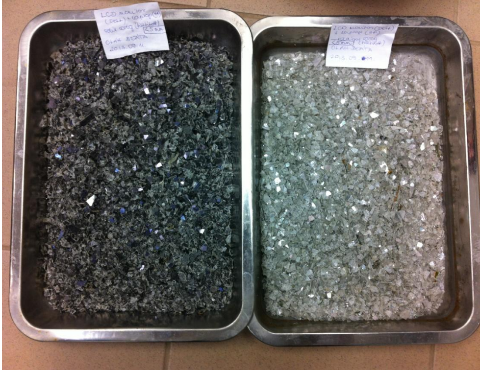
35. ábra: DELL monitorok és HP laptop CF és TFT üvegének aprítóka kalapácsos törő után
