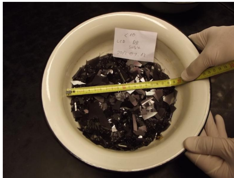
32. ábra: DiBOSS LCD panel CF üvegének törege forgótárcsás nyíróműben való aprítás után
